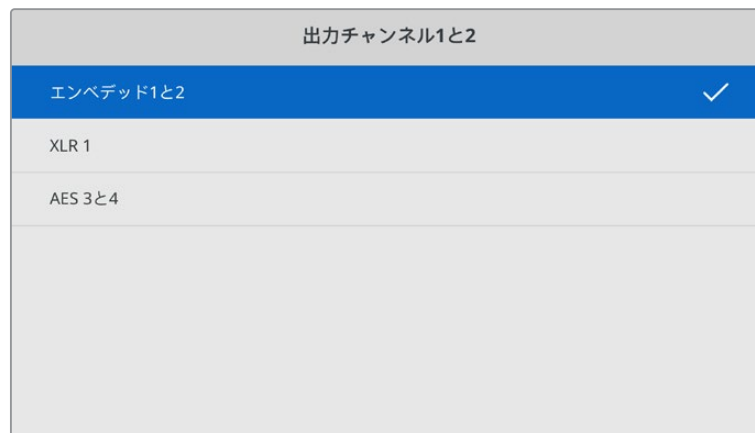
カメラからのエンベッドXLRチャンネルは、チャンネル1と2にマッピング
