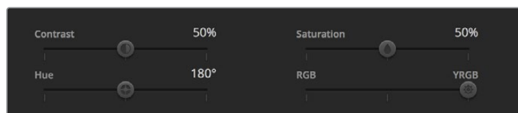
Ziehen Sie die Schieberegler nach rechts oder links, um die Einstellungen für Kontrast, Sättigung, Farbton und Luminanzmischung anzupassen
