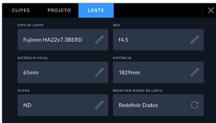
Página “Lente” exibindo informações preenchidas automaticamente de uma lente Fujinon.
