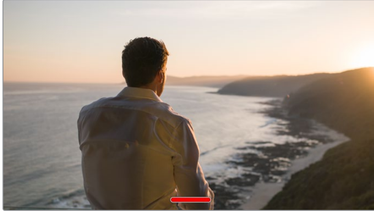
URSA Broadcast G2 kameranızın dokunmatik LCD ekranı, temiz sinyal modundayken de kayıt tally lambasını görüntüleyecektir.
