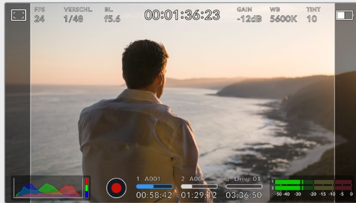
Der LCD-Touchscreen der URSA Broadcast G2 mit aktivierten 14:9-Bildrandmarkierungen
