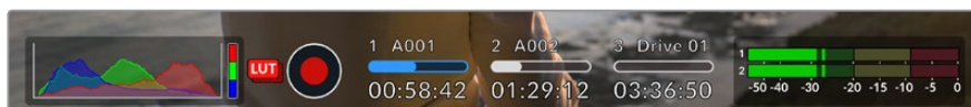
L'icona rossa LUT appare quando si registra in ProRes, H.265 o H.264
