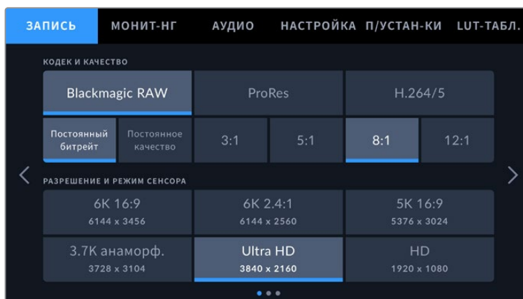
Настройки Blackmagic RAW, выбранные по умолчанию на вкладке «ЗАПИСЬ»
