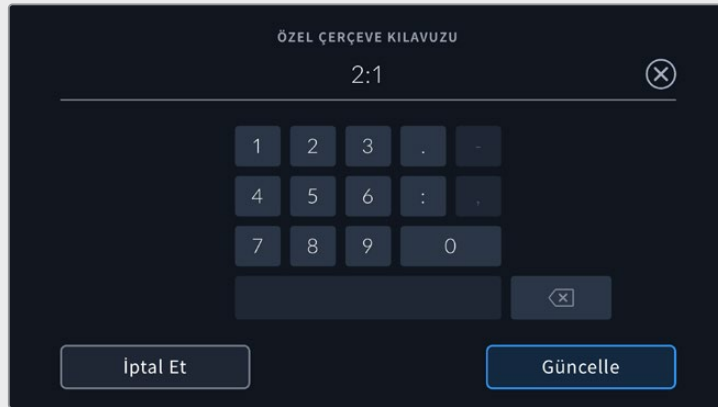
Yeni bir çerçeve kılavuz oranı girmek için, 'özel çerçeve kılavuzu' ekranında sayısal klavyeyi kullanın.
