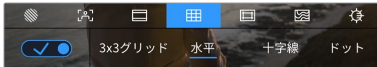
LCDモニターオプションでグリッドアイコンをタップして、URSA Broadcast G2のグリッド設定にアクセス
