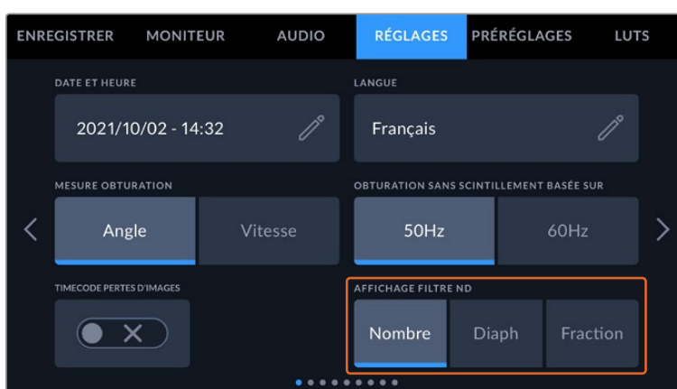
Personnalisez l'affichage des informations du filtre ND à partir du menu Réglages de la URSA Broadcast G2
