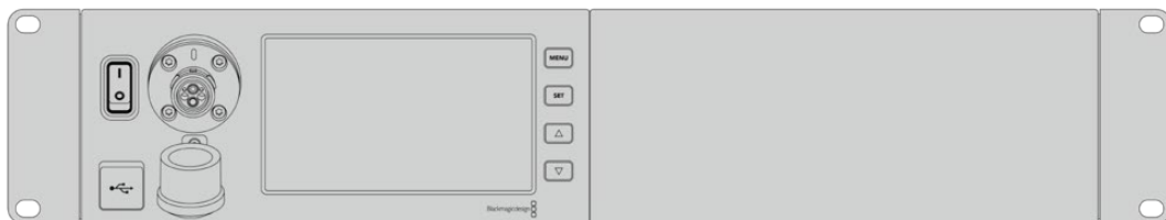
Mit der mitgelieferten Zierblende kann man den ungenutzten Rack-Platz abdecken
