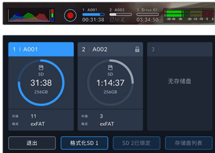
插入了开启写保护锁定的SD存储卡时，URSA Broadcast G2会给出提示。
