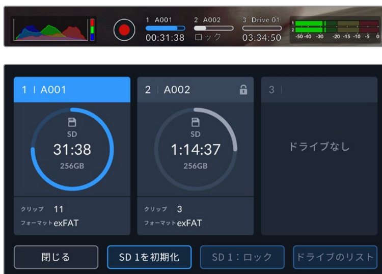
URSA Broadcast G2はロックされたSDストレージメディアが挿入されるとロックアイコンを表示
