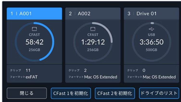
URSA Broadcast G2のLCDタッチスクリーンのストレージインジケータをタップして、ストレージ管理へアクセス
