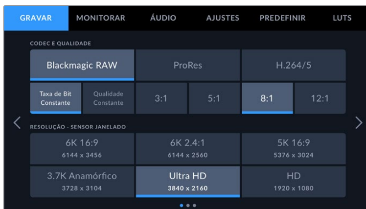
Configurações Blackmagic RAW padrão na aba Gravar.
