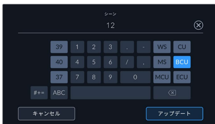
「シーン (SCENE)」メタデータの入力では、URSA Broadcast G2はタッチキーボードの左に増加値の候補、右側にショットタイプを表示
