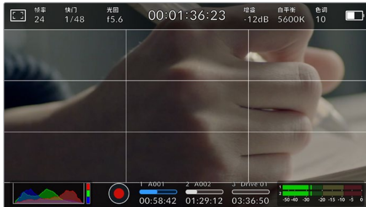
三分法网格可自动缩放放到任意屏幕帧导轨。
