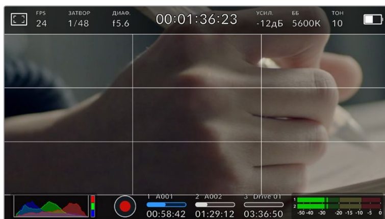
Сетка по правилу трети автоматически масштабируется в соответствии с пропорциями кадра
