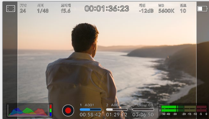
14:9 프레임 가이드가 적용된 URSA Broadcast G2의 LCD 터치스크린
