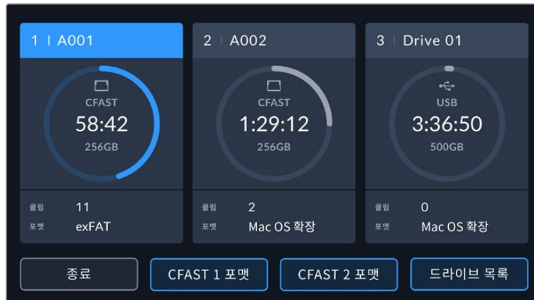
URSA Broadcast G2의 LCD 터치스크린에 있는 저장 미디어 상태 정보를 눌러 저장 관리 화면에 접속할 수 있습니다.
